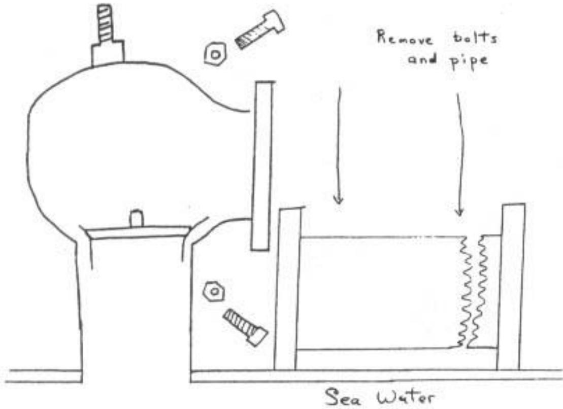
拆下螺栓和管道
