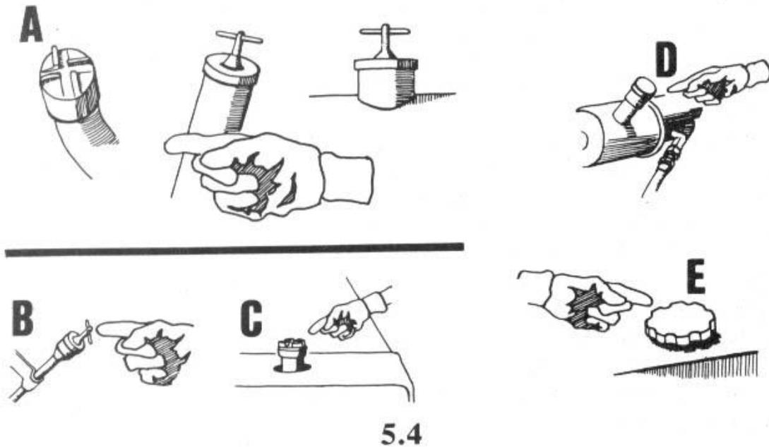
一旦你找到了机油加注口盖，一般很容易借助塑料漏斗灌进干燥的沙子。对于那些把大的机油加注口盖子自带量油尺的机械（这在重型设备里占少数但不少见），插图 5.5 展示了最佳的步骤。旋开并取下加注口盖子/量油尺 (a)。灌进研磨用的沙子 (b)。用大量的喷雾润滑剂把任何一点沙子都向下冲洗到引擎的内部去 (c)。重新插入量油尺并再次拉出来，确保量油尺的表面没有明显粘附沙子。许多操作手每天早上的第一件事是检查各种液位，所以你必须不留下工作的痕迹。（更确切地说，有些公司现在要求每天开动设备前检查所有的液位。）
