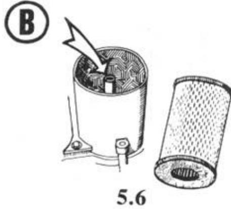
(2), 滤清器外壳将掉进你的手中。把滤清器处理掉 (3), 倒入磨料 (4), 并重新装配起来。第 (5) 张图展示了所涉部件的分解视图。
