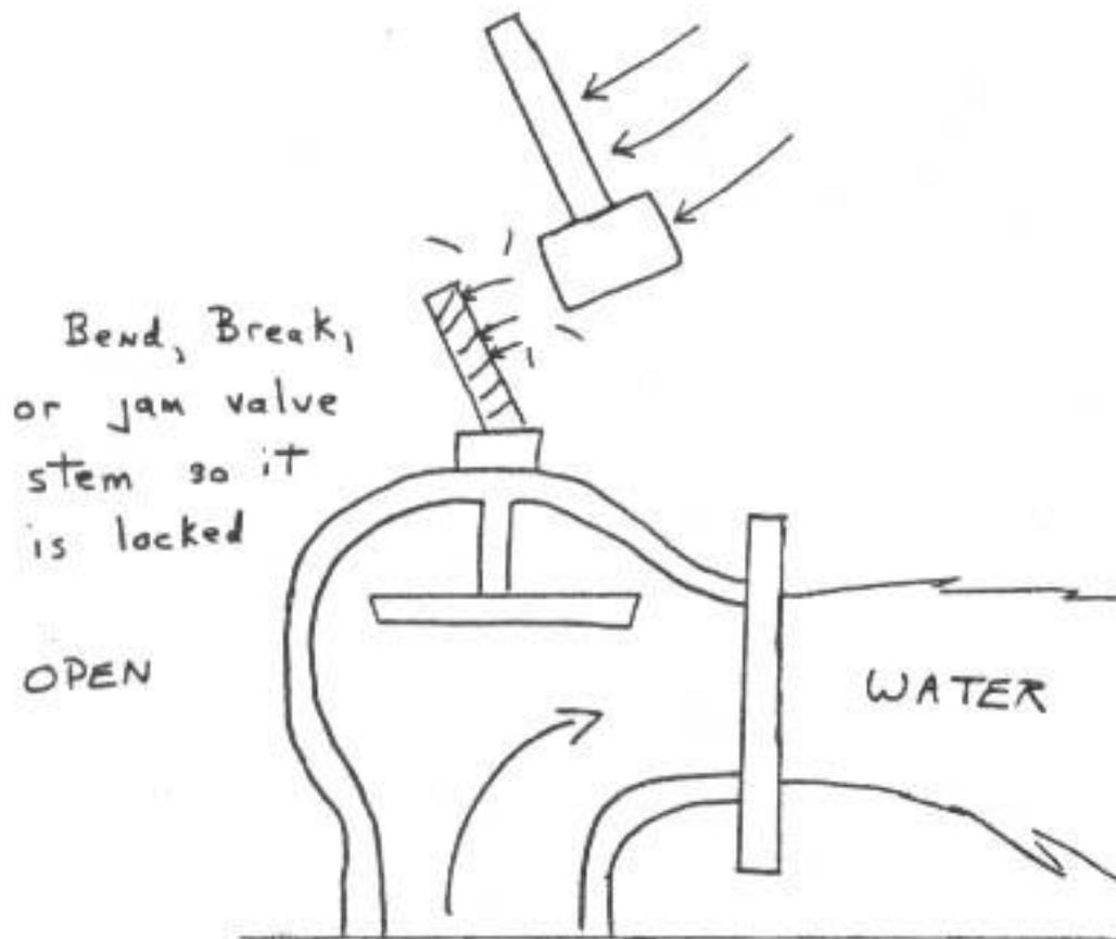
弄弯、折断或卡住阀杆，这样就固定在阀门开启状态
